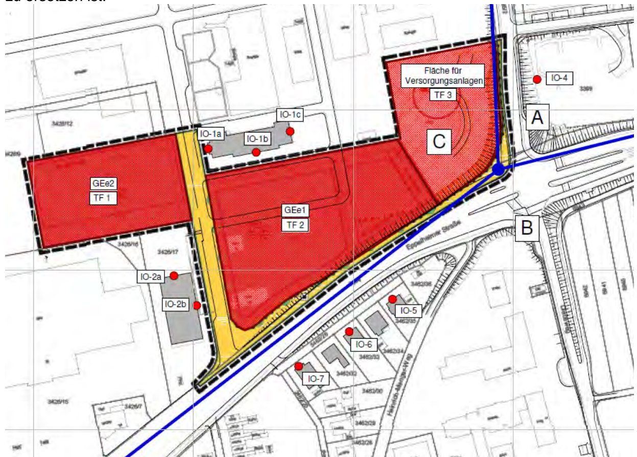
Abbildung 13 Übersicht über die Teilflächen zur Lärmkontingentierung
